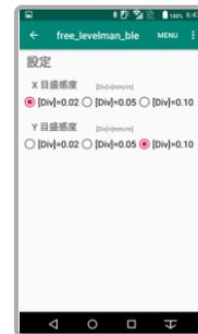
気泡グラフィックの目盛感度はいつでも変更できます。まるで3台の水準器を持っているかのように動作します。
