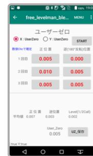
運搬中などの微細なゼロ調整のズレを自動補正します。画面指示で簡単、正確に補正量をSetできます。
