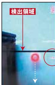
検出領域を設定することで、移動する製品のカウントができます。製品自体をカウントするだけでなく、例えば金型に「カラーシール」を貼り付けてプレス機のショット数をカウントすることも可能です。
