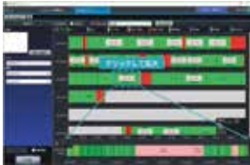
タイムチャートで稼働状態の詳細表示 工程内一時停止の推移から人の動きの推測も可能
