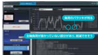
切削負荷が掛かっていない箇所や、負荷のパラツキを複数個で検証可能。また、切削力が一定となるよう加工条件を変更した NC プログラムの自動作成可能
