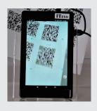
工程にあるタブレットのカメ ラ機能を利用し、工作機械、 設備機器、部品棚などに QR コードラベルを読み取ること で現場で設備情報を見たり、 入出庫部品数を入力したりで きます。ペーパーレス化が可 能、設備メンテ情報の確認、 入出庫作業時間の短縮につ ながります。
