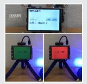
騒音の大きな現場で情 報伝達を行うための製 品です。工程にあるタ ブレットを利用し、情 報の既読確認機能、情 報通信ログも残ります。 情報伝達のロスをなく します。
