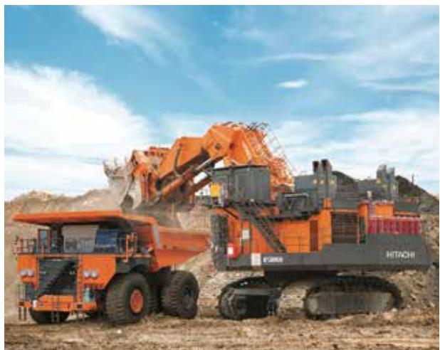
大型ダンプトラックEH5000AC-3(左)、超大型油圧ショベルEX8000-6(右)(写真提供:日立建機)
