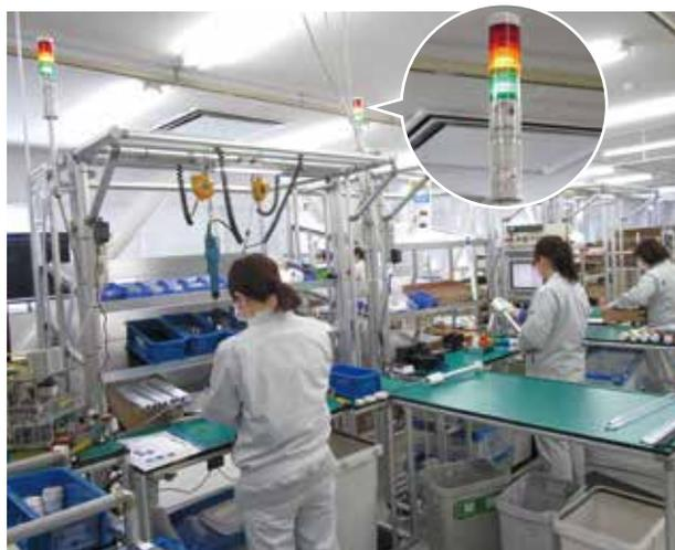
2017年11月から三田工場に導入された「AirGRID® WD」。主力生産ラインの稼働管理が開始された。
