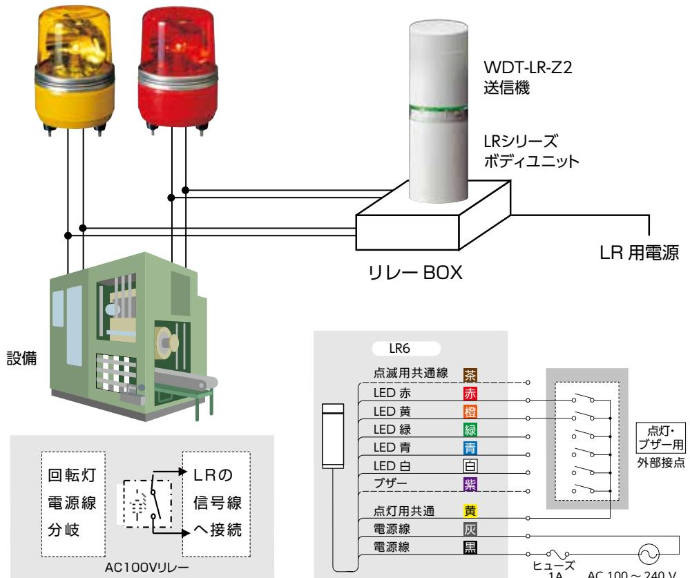
LE、LME型等、LR型以外の表示灯も同様に信号線の分岐で稼働データが収集できます。
