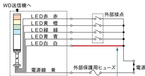
電源供給に割り当てた信号線 (この図では白) と電源線 (黄) に電圧を印加します。
