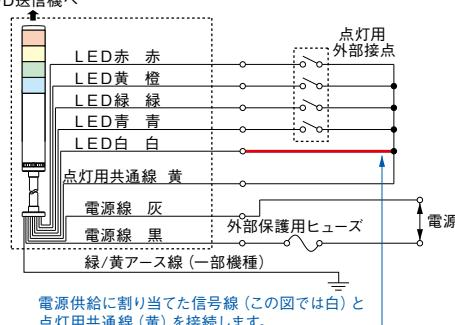
※送信機（WDT）用の電源線は必ず配線してください。
