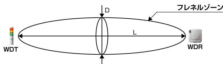
見通し距離 L : 20m の場合 → フレネルゾーンの直径 D : 1.6m程度
