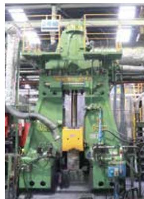
大智鍛造所で稼働する大谷機械製作所製の鍛造設備
